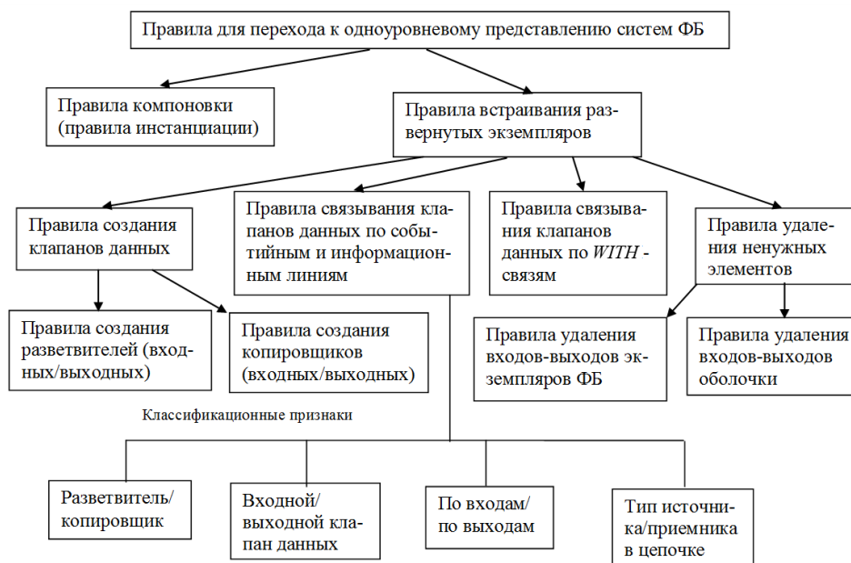
Рис. 11. Классификация правил перехода от многоуровневой структуры систем ФБ к одноуровневой структуре
